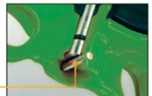
Wellensicherung erfolgt mittels Sicherungsstift
