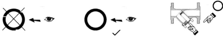
Sollte die Deckeldichtung irgendwelche Beschädigungen aufweisen, so tauschen Sie diese unbedingt aus. Nur eine absolut einwandfreie Deckeldichtung gewährt eine zuverlässige Abdichtung des Schmutzfängers.
