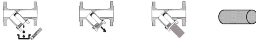
Wenn der Deckel entfernt und die restliche Flüssigkeit ausgetreten ist, können Sie das Sieb ebenfalls einfach nach unten aus dem Schmutzfänger herausziehen.
