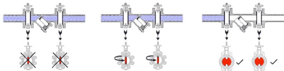
Bei allen Wartungs- und Reinigungsarbeiten am Schmutzfänger vorher die Absperrorgane vor und hinter dem Schmutzfänger schließen, so dass kein Medium mehr nachströmen kann und der Schmutzfänger druckfrei ist.
