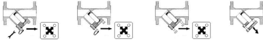
Lösen Sie die Muttern des Deckelflansch mit einem geeigneten Werkzeug. Bitte achten Sie darauf, die Muttern über Kreuz zu lösen und auch über Kreuz ausdrehen, um ein Verkanten des Deckels zu verhindern.
