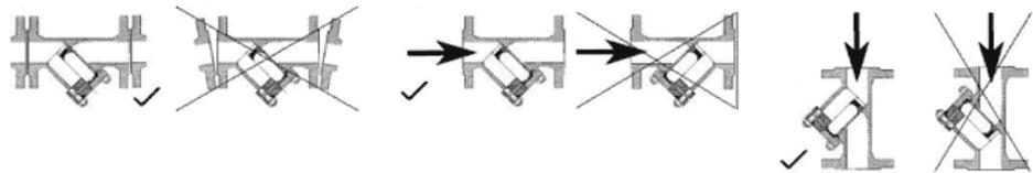
Den Schmutzfänger mit Siebkorb nach unten in Strömungsrichtung (siehe Pfeil auf dem Gehäuse) einbauen.
