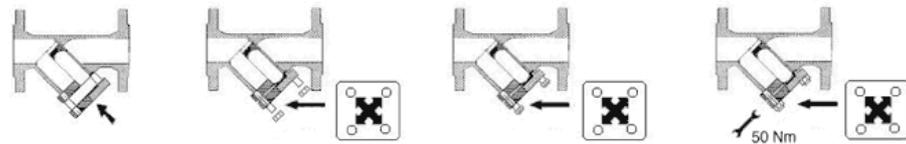
Setzen Sie dann den Deckelflansch wieder auf den Schmutzfänger auf, schrauben Sie die Muttern über Kreuz auf die Haltegewinde. Zum Schluss die Muttern - über Kreuz - mit dem vorgeschriebenen Drehmoment (50 Nm) fest anziehen.
